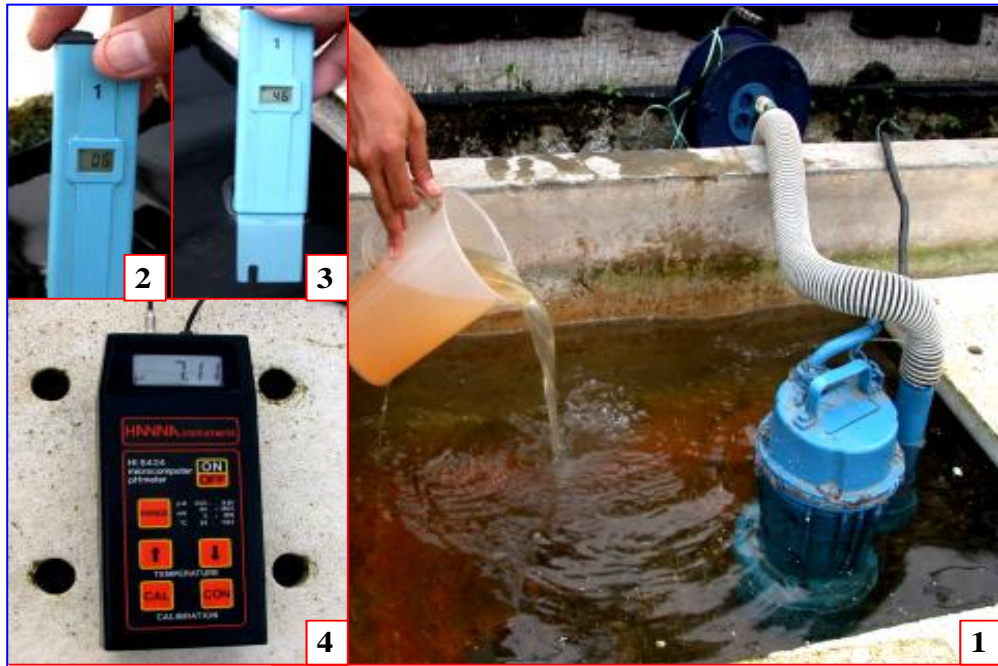
Gambar 3. Persiapan Larutan Hara. (1). Pencampuran larutan stock ke dalam kolam tanam, (2). Pengukuran konsentrasi awal (60 ppm TDS), (3) Pengukuran konsentrasi larutan setelah ditambah hara (660 ppm TDS), (4) Pengukuran konsentrasi pH.
